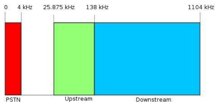
Слика 2. Шема коришћења фреквенцијског опсега бакарне парице
